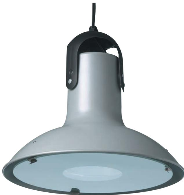
Luminaire à suspendre au plafond avec une chaînette ou un filin acier. Il se compose d'un corps extérieur en aluminium repoussé revêtu d'une poudre époxy polyester à l'intérieur duquel sont logés un réflecteur et l'équipement électronique l'ensemble étant fermé par un verre trempé .
